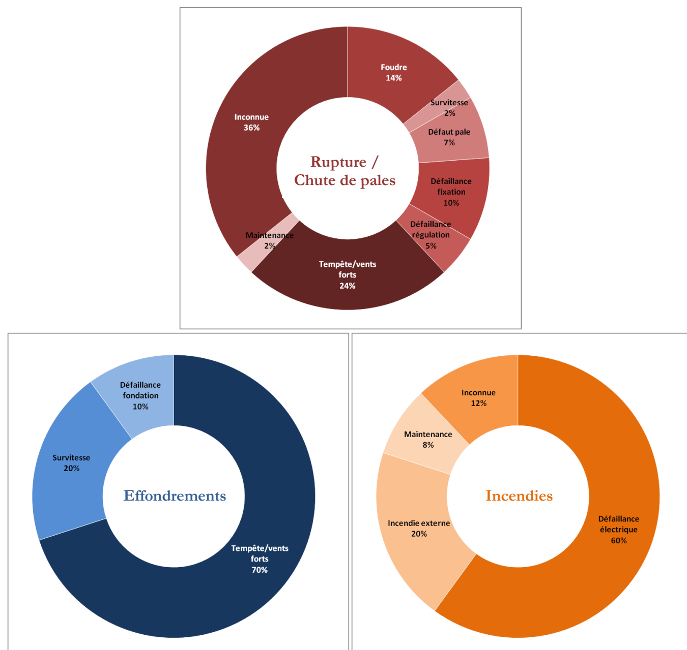
Figure 7 : Répartition par cause des principaux événements accidentels sur le parc éolien français entre 2000 et 2020 (Source : BE Jacquel et Chatillon)
